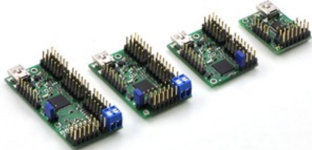
Maestro family of USB servo controllers: Mini 24, Mini 18, Mini 12, and Micro 6.
