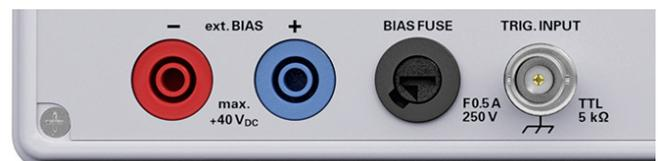
Abb. 4.2: Ausschnitt Geräterückseite mit Sicherung
