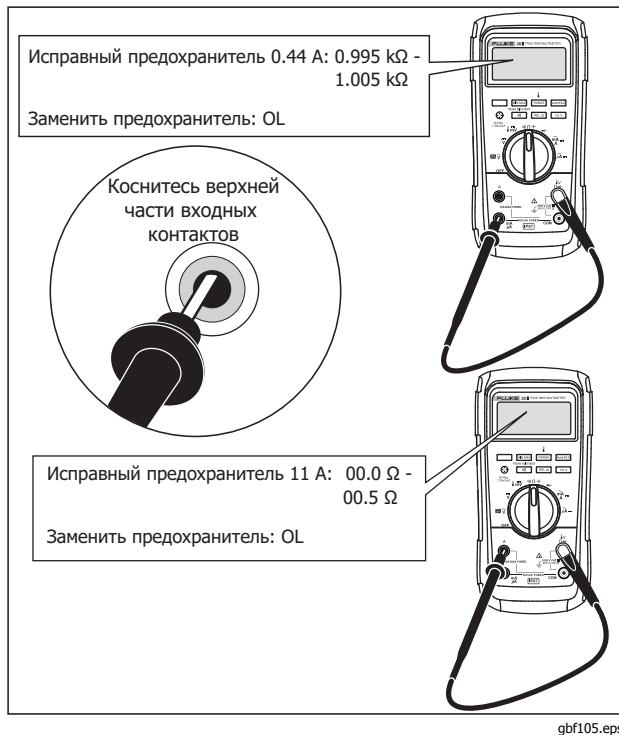
Figure 10. Проверка предохранителей
