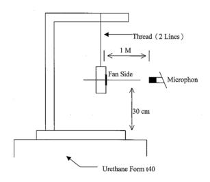
1 METER FROM MICROPHONE TO FAN INTAKE
