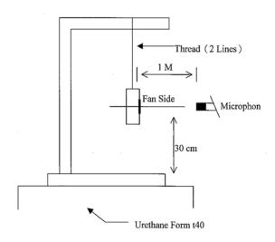
1 METER FROM MICROPHONE TO FAN INTAKE
