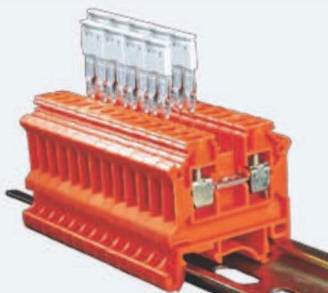
Przykład połączenia zwieraczem wtykowym 2-polowym szeregu złączek szynowych. Umożliwiają to otwory w torze prądowym pozwalające na naprzemiennie wpinanie zwieraczy.
