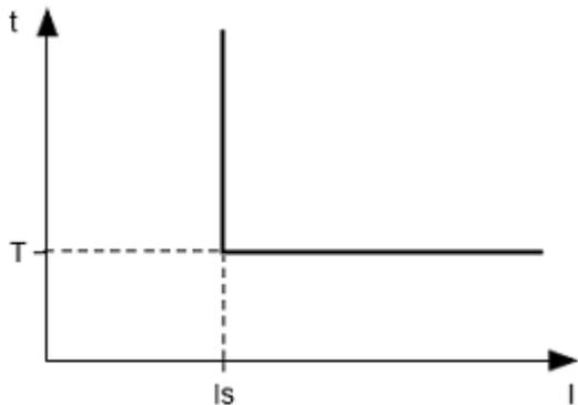
$I_s = "i \cdot t"$  (кратность срабатывания) \*  $I_n$  (номинальный ток нагрузки), а  $T$  - времени задержки срабатывания защиты
