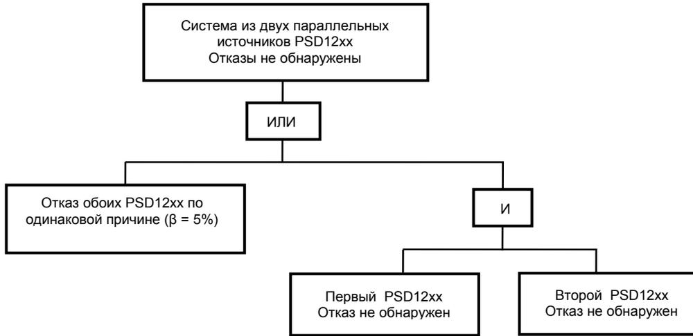
Рис. 1: Дерево отказов для двух источников питания, включенных параллельно (два PSD1210 или PSD1206)
